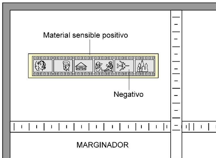
Para realizar una buena muestra de contacto deberá primeramente ensayarse los tiempos de exposición en una tira de prueba para posteriormente realizar un revelado rápido y seleccionar el tiempo de exposición correcto.
